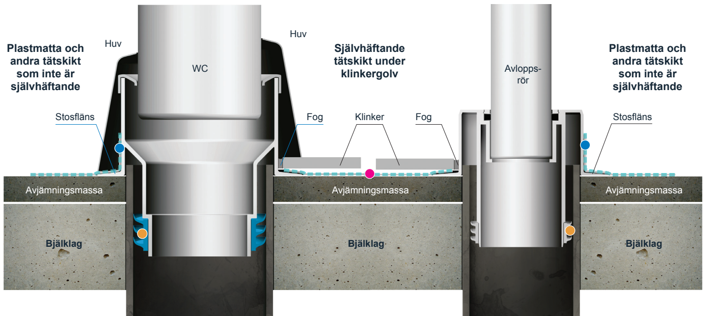
Exempel på golvanslutningsstos (GAS)
